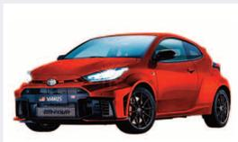
**Motore:** 3 cilindri turbo da 1618 cc, 280 cv, 4 ruote motrici, cambio automatico ad 8 rapporti.
