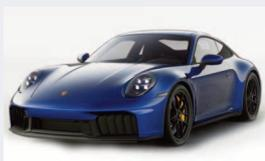
**Motore:** 6 cilindri biturbo T-Hybrid da 3591 cc, 541cv, quattro ruote motrici, cambio automatico ad 8 rapporti.
