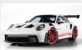
**Motore:** 6 cilindri aspirato da 3996 cc, 525 cv, trazione posteriore, cambio automatico a 7 rapporti.
